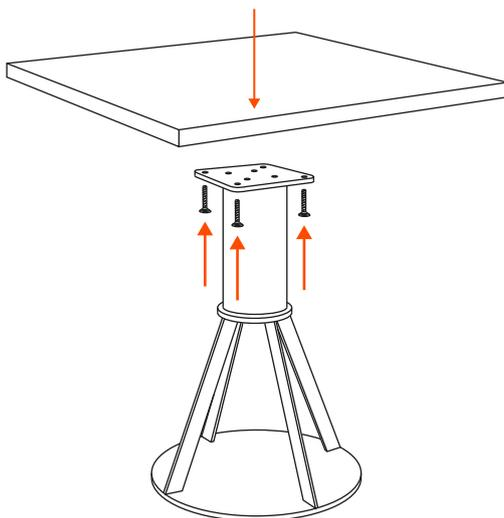
Avvitare la piastra della gamba centrale al piano del tavolo con le viti M10x25 in dotazione. | Fix the metal plate of the central leg to the table top with M10x25 screws.
