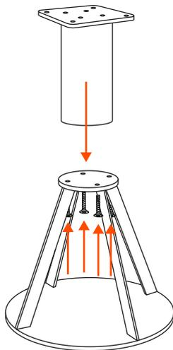
Avvitare la piastra di base alla gamba centrale usando le viti M10x35 in dotazione | Fix the base plate to the central leg with M10x35 screws.
